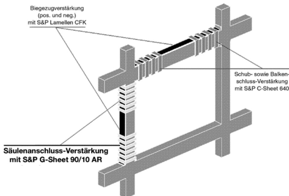
Image 58: Renforcement de cadre en béton armé
