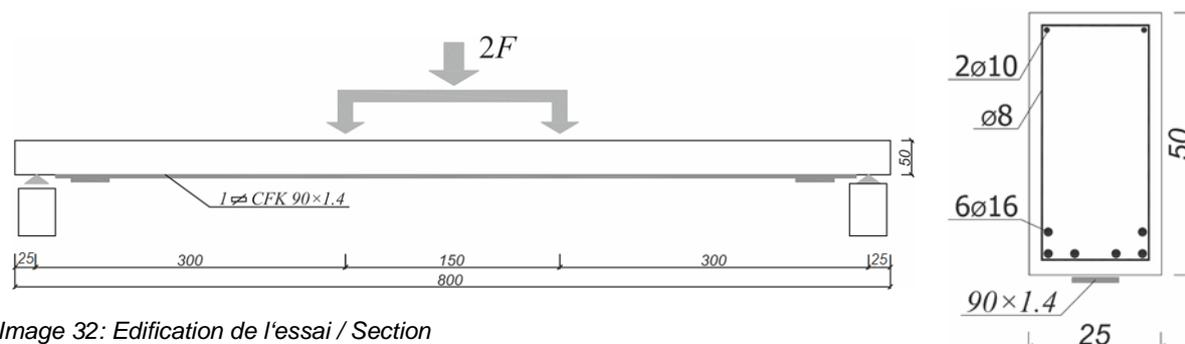
Image 32: Edification de l'essai / Section
