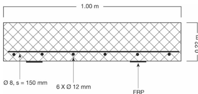
Image 30: Coupe de la dalle en béton
