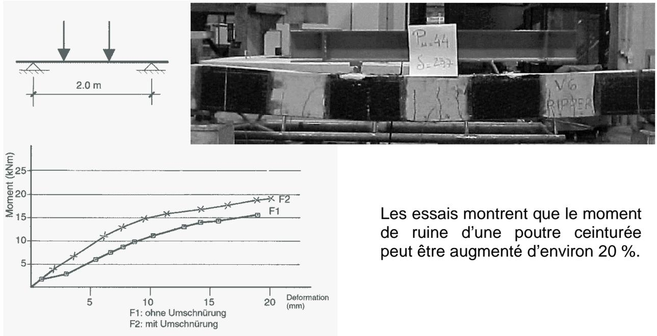
Les essais montrent que le moment de ruine d'une poutre ceinturée peut être augmenté d'environ 20 %.
