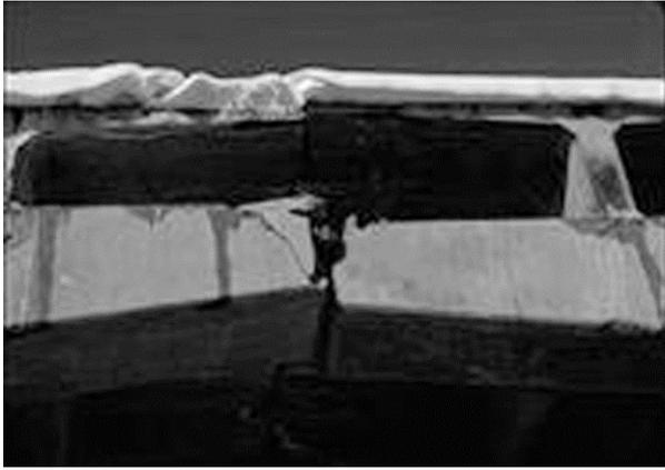
Image 57: Rupture par cisaillement dans une articulation plastique
