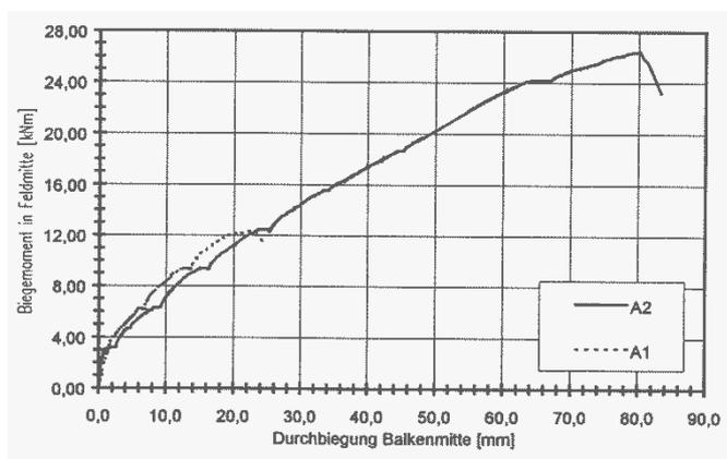
Image 21: Courbe moment-déformation des essais A1 et A2
