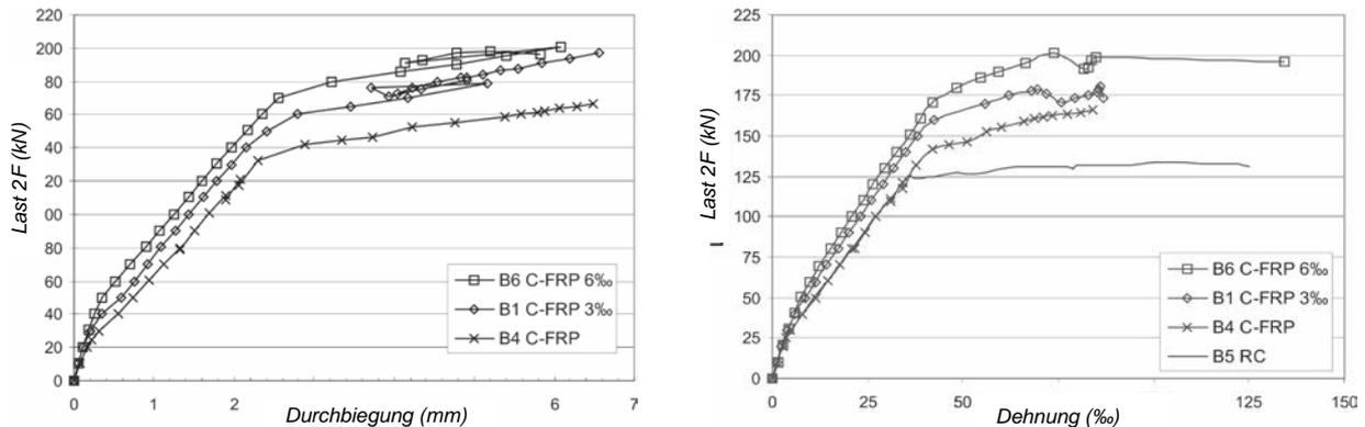
Images 34 / 35 : Résultats d'essais: Diagramme force-flèche (gauche) et diagramme force-allongement (droite)
