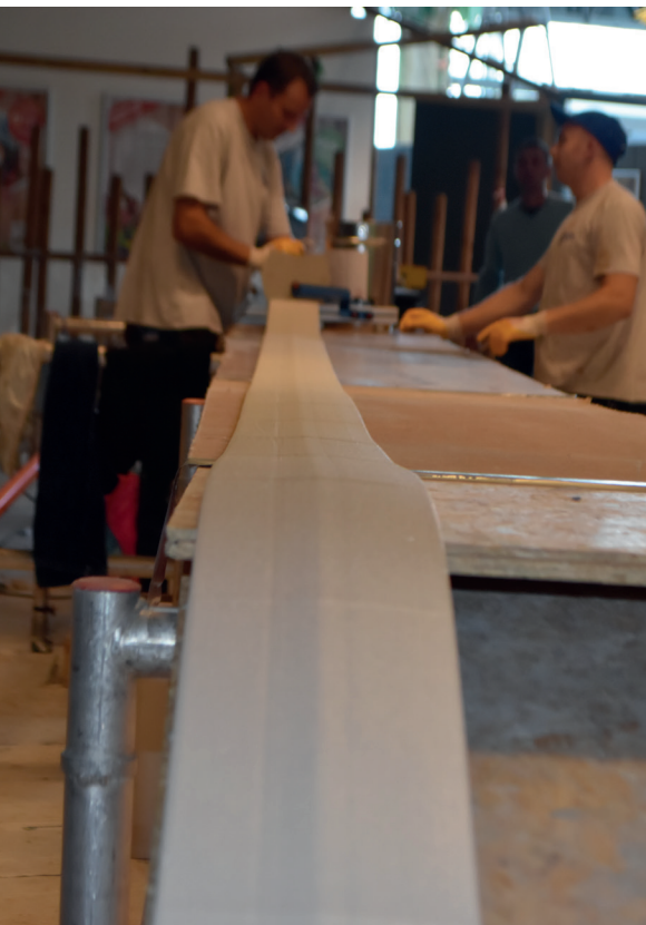
Opstelling aanbrengen lijm
