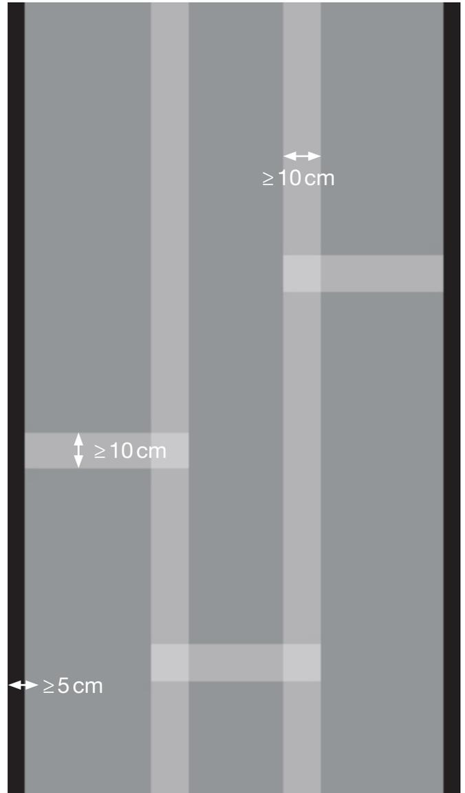
Recommandation pour le positionnement et l'espacement des recouvrements
