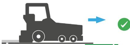
Les recouvrements transversaux doivent être disposés de manière à ce qu'ils ne puissent pas être repliés par le finisseur.
