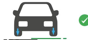
Les chevauchements longitudinaux doivent être placés autant que possible en dehors de la trace idéale du pneu.
